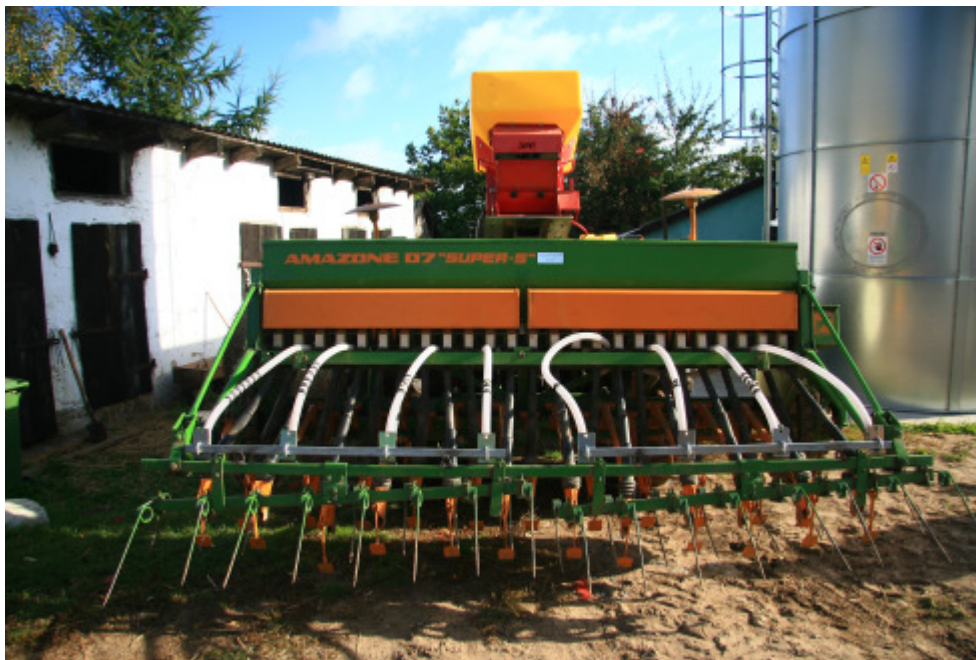
Die neue, moderne Drilltechnik, mit der computergesteuert z. B. Leindotter und Getreide gleichzeitig gesät werden können
